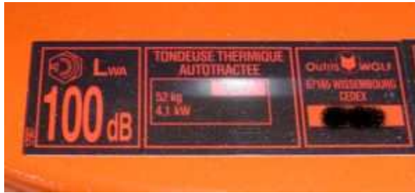
Exemple de niveau sonore inscrit sur le carter d'une tondeuse
